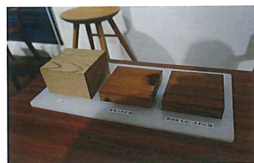
【杉の材料】左=素材 右=圧縮・乾燥後
